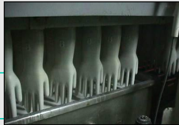
Namáčení ve srážecím činidle
